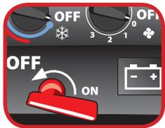
**5/** Motor abstellen. / Falls möglich Batterie isolieren, indem der Hauptschalter aktiviert wird. Klimaanlage / Heizung abstellen.
